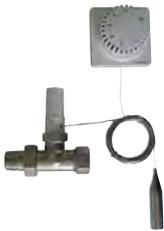
Temperatur-Regeleinheit für Warmwasser-Heizregister MBW 200 bis 315, bestehend aus einem Thermostat mit Kapillarrohr-Fernfühler und einem Durchgangsventil. Für eine Temperaturregelung wird der Durchfluss stufenlos an den Wärmebedarf angepasst.
